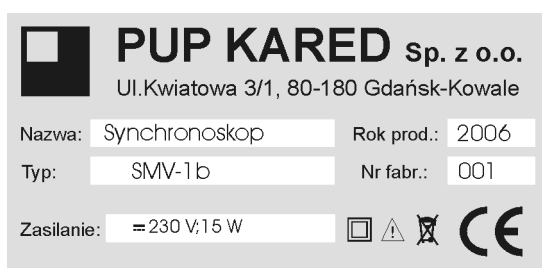
Rys. 2. Образец таблички номинальных данных
