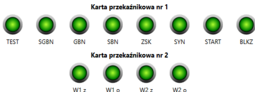
Rys. 6.19. Sekcja sterowania wyjściami przełącznikowymi przy aktywnej opcji: Ukryj niewykorzystywane WE/WY, synchronizator: SM-06-B
